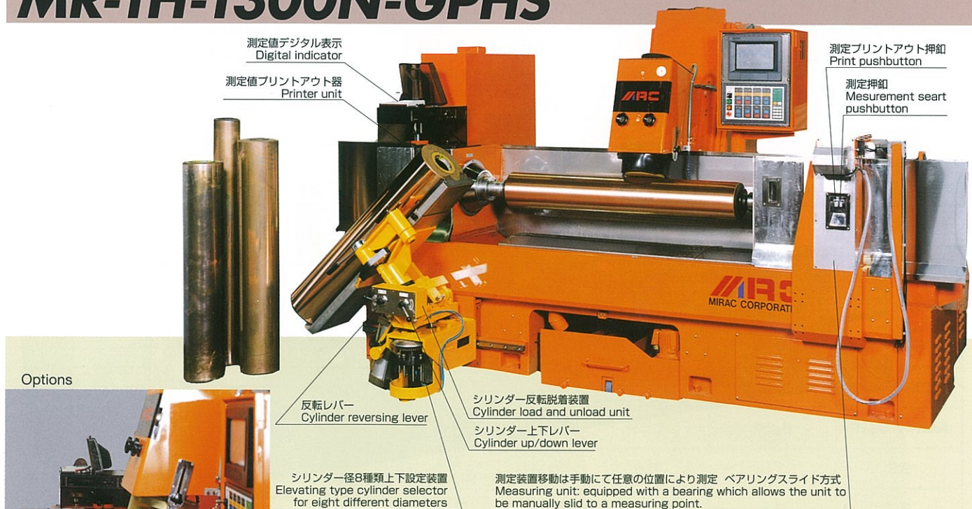
グラビア印刷シリンダー専用機 砥石ヘッド全自動方式 操作盤グラフィックパネル(GPP)方式 ロール径測定装置 \phi 120 \sim \phi 300 \text{mm} デジタル表示及びプリントアウト方式(オプション) Dedicated machine for gravure printing cylinders Full-automatic grindstone head type Graphic control panel (GPP) Measurement apparatus for roll diameters ( \phi 120 \sim \phi 300 \text{mm} ) Digital indicator and Printer unit (optional)
