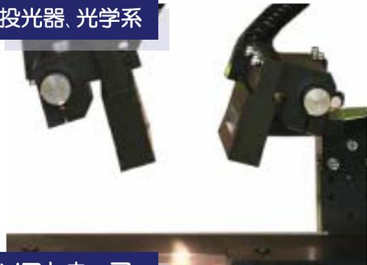
高周波点灯蛍光灯、ブラックライト、ハロゲン、メタルハライド、LED等の中からラインカメラの分光特性、対象物の反射特性、透過特性等を考慮し、検出に最適の光源を光学フィルター、照射方式と合わせてご提供します。
