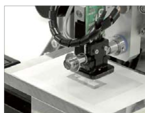
シングルノズルヘッドでのベクター スキャン方式描画
